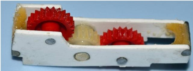
Vom intakten Getriebegehäuse 91754 wurden die Seitenteile auf einen 1.0 mm dicken Kunststoff kopiert, die Bohrungen abgebohrt und die abgebrochenen Achsen eingesetzt. Nach dem Einbau der Zahnräder und dem Fügen der Seitenteile, Verklebung mit einem 2K-Klebstoff.
