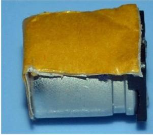
Schutzpapier abziehen und den ELKO in das Tenderunterteil 91750 isoliert einkleben.
