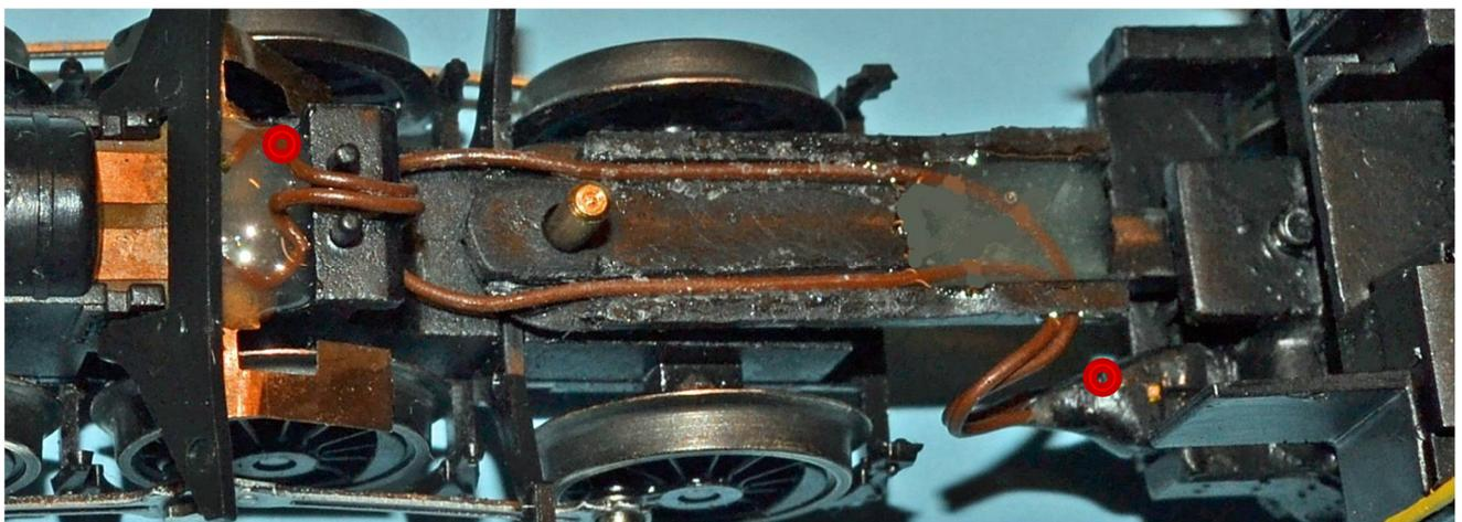
Litzen in den Kanälen sauber verlegen und mit einem Sekundenklebstoff fixieren. Am Ende mit einem 2K-Klebstoff befestigen, füllen.
