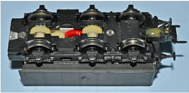
Radsätze einlegen. Getrieberahmen 91751 vorne anheben, über die Kupplung nach vorne schieben und passend absenken.
