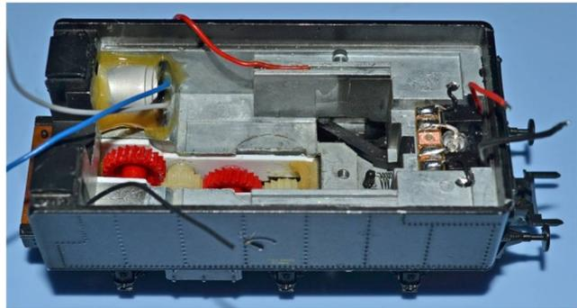
An den Pluspol des ELKOS eine blaue Litze und an Minuspol eine graue Litze löten. ELKO mit einem 2K-Klebstoff gut gegen das Tenderunterteil isoliert befestigen.
