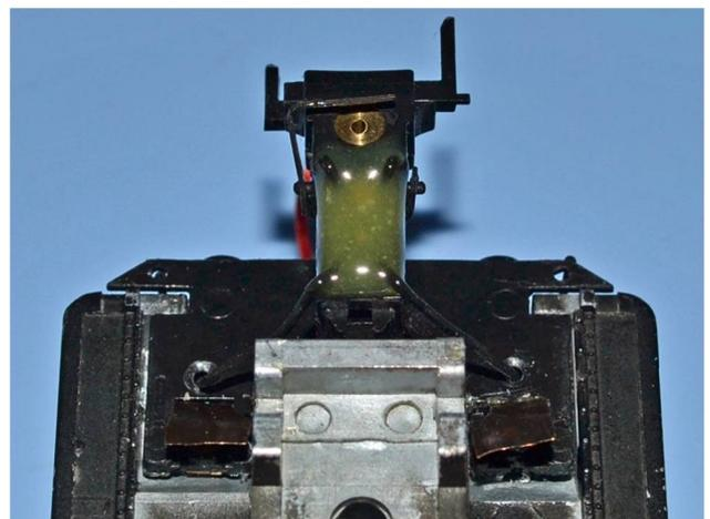
Litzen am Normschacht mit einem Sekundenklebstoff fixieren und mit einem 2K-Klebstoff befestigen.
