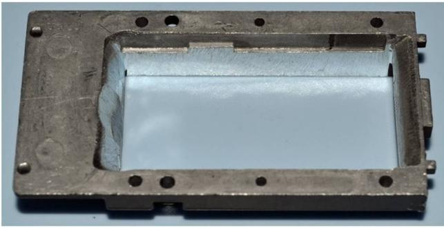
der Kohlenkastenaufsatz über die Komponenten ohne anzustreifen einsetzen lässt. Vorne eine Facette und hinten eine halbrunde Freistellung für die Litzen feilen.
