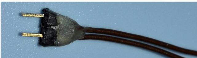
Von einer Stiftleiste 2-Pole abtrennen und zwei 120 mm lange Litzen anlöten. Lötungen mit einem 2K-Klebstoff isolieren und an einer Seite eine Schräge anbringen (Schwenkbereich der Lok-Deichsel = Polmarkierung Schiene rechts).
