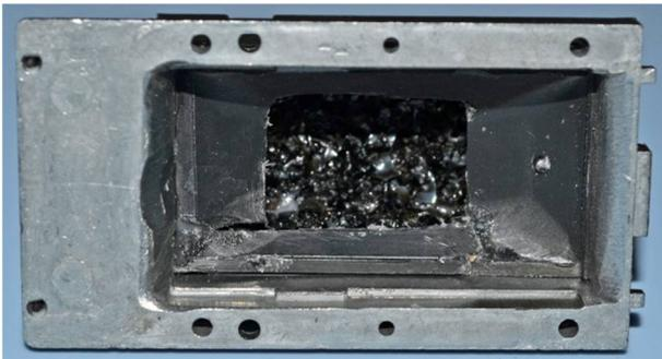
Die Kohlenimitation 93950 mit einem Sekundenklebstoff in den Kohlenkastenaufsatz einkleben. Eine Freistellung in der Grösse des Lautsprechers in der Kohlenimitation ausnehmen. Sämtliche Komponenten mit einer Kunststoff-Folie sauber abdecken. Kohlenkastenaufsatz dicht über die Kunststoff-Folie montieren und mit den 2 Schrauben 85672 M2x6 mm befestigen.
